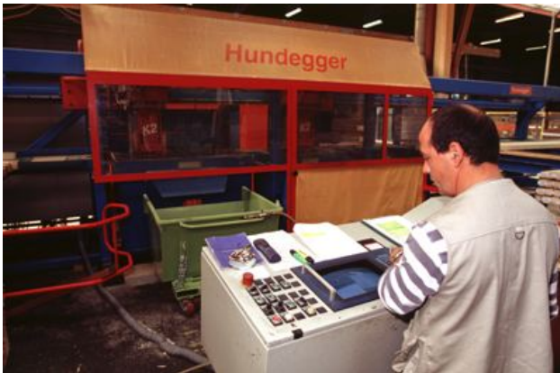
Le centre d'usinage numérique Hundegger
